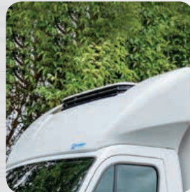
Déflecteur aérodynamique avec découpe tridimensionnelle pour groupe
